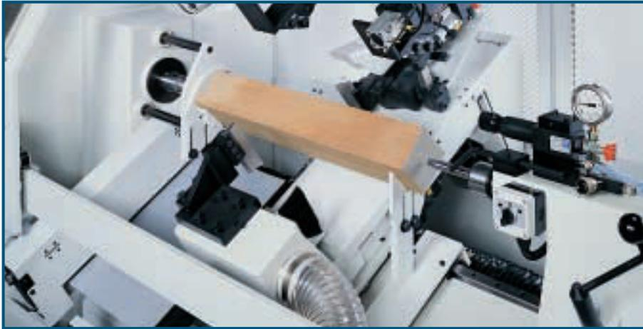
Supporti a "V" per il centraggio di pezzi quadri oltre 100 mm fino a 178 mm max.
