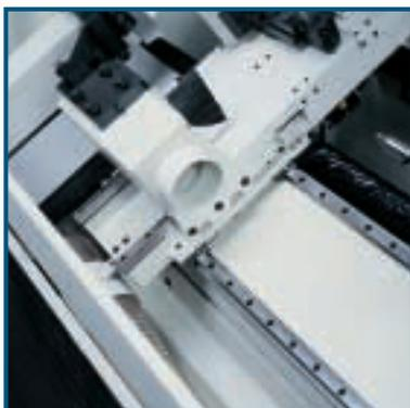
Guide di scorrimento carro in acciaio temprato ad alta resistenza e intercambiabili. Garantiscono la massima precisione di spostamento longitudinale del carro con velocità fino a 30 mt./min.
